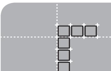
Pour déterminer l'emplacement des carreaux et les coupures à effectuer, commencer par mettre les carreaux en place sur le plancher en plaçant une rangée de carreaux le long de chaque ligne en insérant aussi les cales d'espacement. Reporter ensuite les mesures sur le mur.
