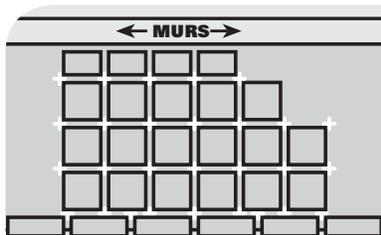
Faire un essai en installant le plus de carreaux entiers possibles sur la surface en insérant aussi les cales d'espacement. Si le comptoir bute sur un mur, placer des carreaux coupés le long du mur, au besoin.
