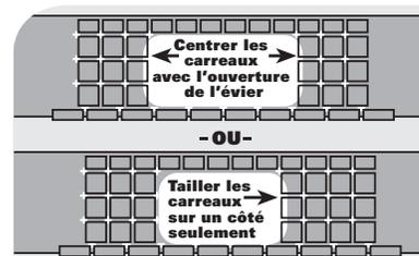
Pour les dessus de comptoirs droits, marquer le centre de la surface du comptoir ou de l'évier et vérifier que les carreaux de chaque cotés de l'évier soient de la même largeur. Éviter d'installer des carreaux coupés de plus de la moitié en décalant la mise en place d'un demi-carreau de chaque côté.
