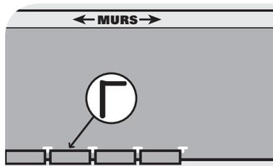
Débuter la mise en place des carreaux à bords arrondis ou en forme de V en les positionnant sur le devant du comptoir.
