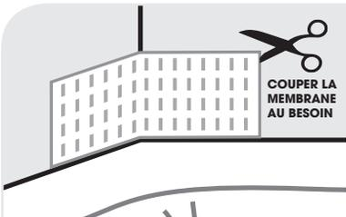
Une feuille simple de membrane SimpleMat doit recouvrir les coins en laissant un excédent d'au moins 25 mm (1") sur chaque mur.
