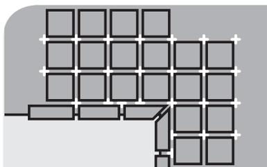
Pour les comptoirs en forme de L, installer des carreaux entiers au coin intérieur. Installer les pièces à bords arrondis ou en forme de V pour être certain du nombre exact de pièces en surplomb.
